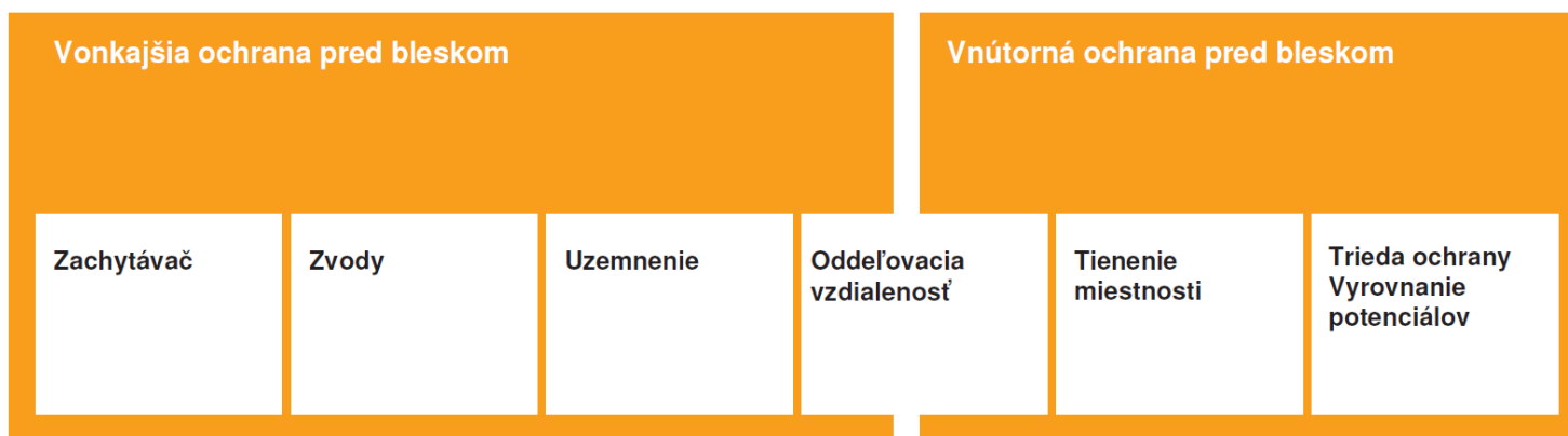
Obrázok 2: Systémy a opatrenia vonkajšej a vnútornej ochrany pred bleskom
