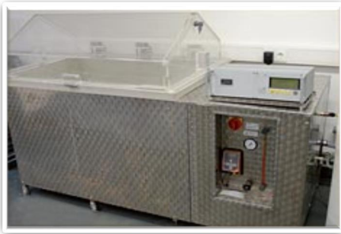
Obr. 5 Zariadenie na simuláciu prostredia – soľná hmla
