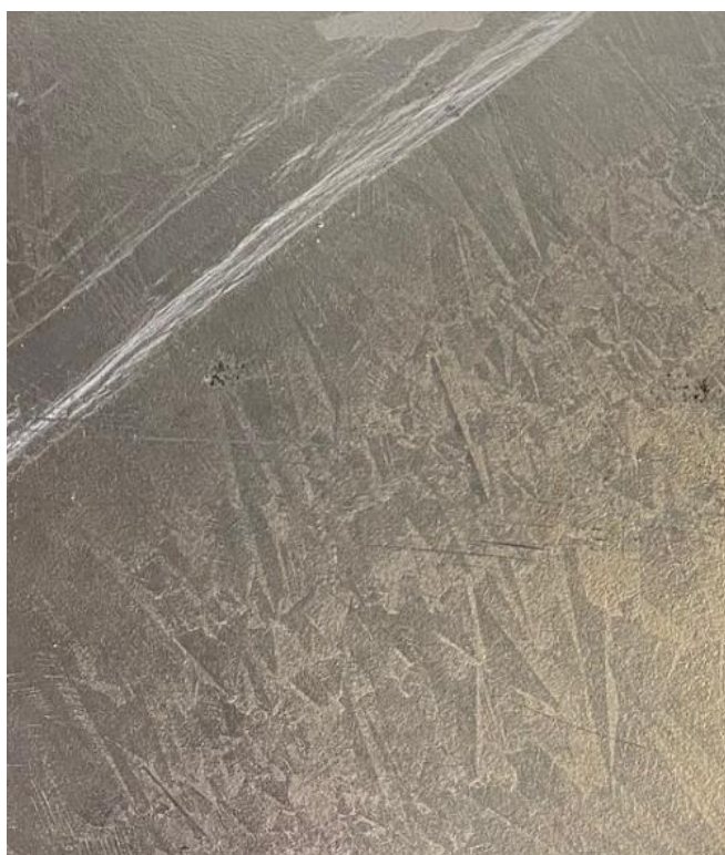
Obr. 5: Ukážka bielej škvrny (tzv. biela hrdza)
