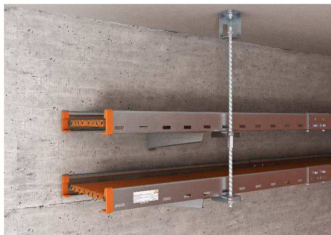
Obr. 11: Káblový rošt LG-VSF nainštalovaný na výložníkoch a zabezpečený závitovou tyčou pripevnenou k stropu
