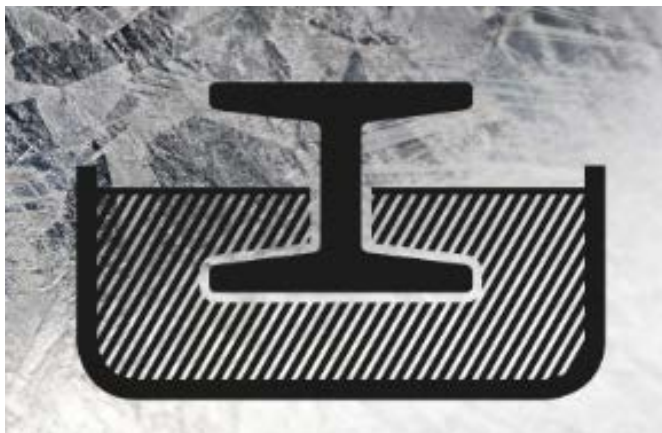
Obr. 12: Zinkovanie oceľových dielov ponorom
