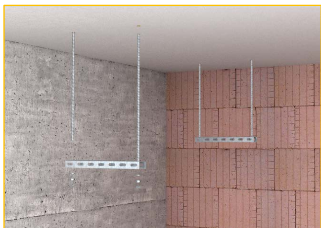
Obr. 11: Montáž závitovej tyče pomocou šesťhranných matíc a veľkých podložiek
