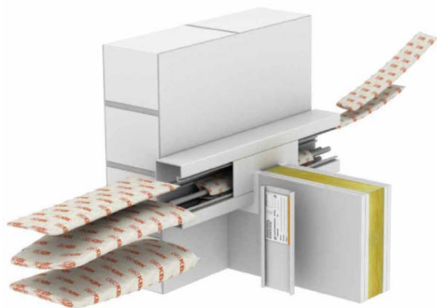
Obr. 12: Utesnenie plastového kanála pri prestupe cez požiaru prepážku
