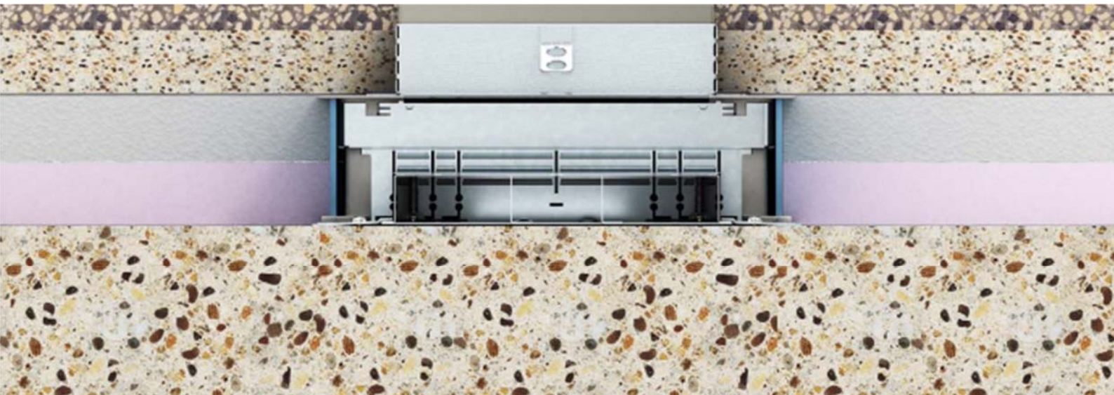
Obr. 4: V terazzovej podlahe je podlahová zásuvka zarovnaná s izolačnou vrstvou a podlahová krabica je nastavená do výšky tak, aby zodpovedala úrovni dokončenej podlahy
