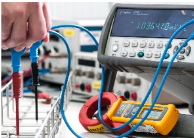
Obr. 4: Meranie prechodového odporu spoja
