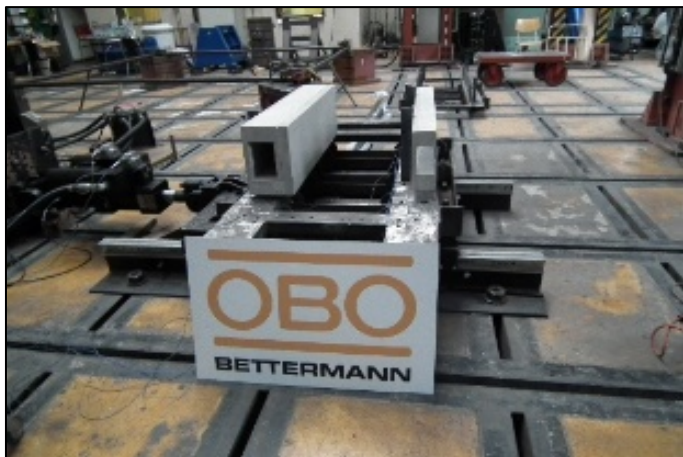
Obr. 8 a 9: Seizmické skúšky kanálu PYROLINE® Con a strmeňových príchytiak s kovovými rúrkami
