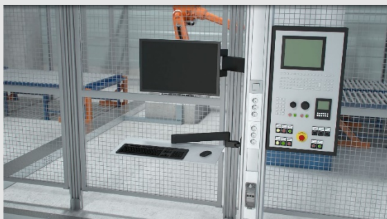
Obr. 3: Systém inštalačných stĺpov ISS pre priemyselné využitie.
