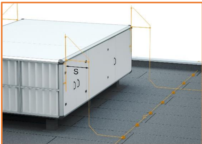
Obr. 7: Príklad zachytávacieho systému s kombinovaným setom Iso pre trojuholníkové vedenie vodiča.
