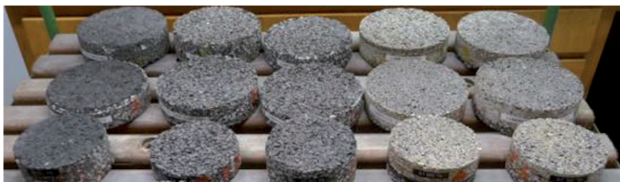
Obr. 5 Špeciálne upravené vzorky povrchu vozoviek (zdroj: TU v Drážďanoch)
