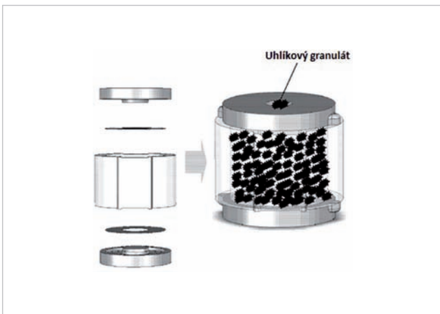
Obr. 5 Zapuzdrená patróna s uhlíkovým granulátom
