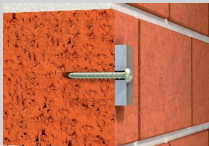
Provedení s plochou kulovou hlavou a T-drážkou.
