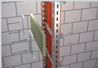
Montáž opěrné desky pomocí šroubů se šestihlannou hlavou na zavěšenou stoupací trasu.
