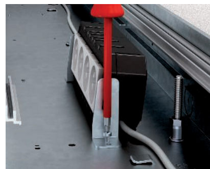
Montáž přístrojové vložky a nosiče modulu do spodního dílu kanálu. Při připojení instalačních přístrojů namontujte přístrojový nosič na nosič modulu nebo přístrojovou vložku. Celou jednotku přišroubujte ke spodnímu dílu kanálu.
